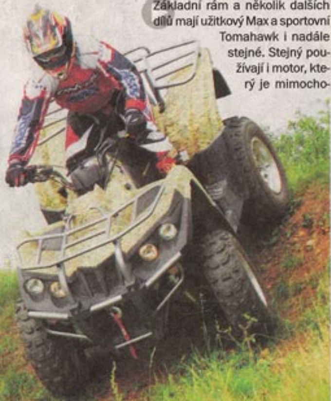
■ Dělená náprava u Maxe dovoluje, oproti starému modelu, mnohem větší nasazení v trialových sekcích
